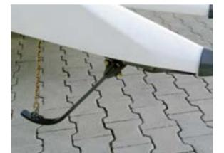
Скобы-копир определяют положение жатки для AUTO CONTOUR и CONTOUR.
