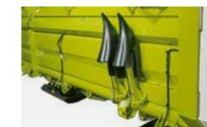
Положение навески на жатке для наконечника стеблodelителя при транспортировке.
