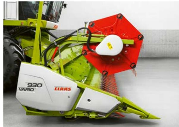
Стол жатки задвинут – уборка зерновых (-100 мм).
