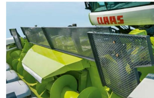
Регулировка початкоотделительных пластин.
