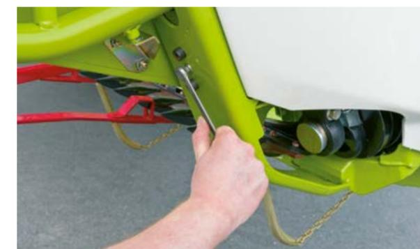
Простая регулировка стебледелителя по высоте с помощью складного ключа.
