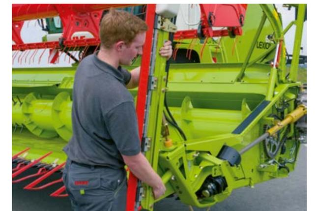
Установка рапсовых ножей с помощью быстродействующего затвора.
