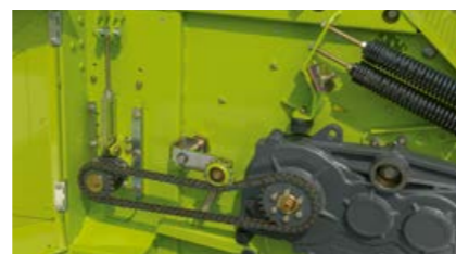
DIRECT DISC 600 P/500 P: регулирование высоты лопастного вальца, опционально также гидравлическое.
