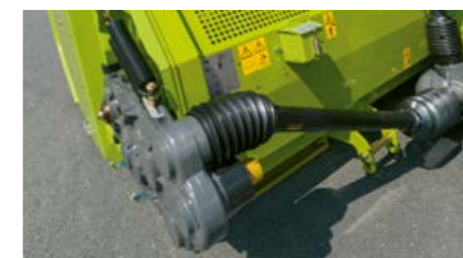
Мощная трансмиссия с трехступенчатым редуктором.
