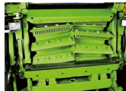
Микроударные планки для 800-й серии
