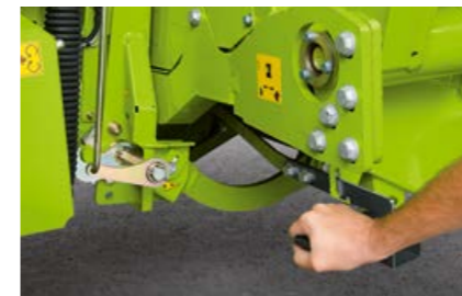
Двухступенчатое регулирование частоты вращения втягивающих конусов в ORBIS с Т-приводом.
