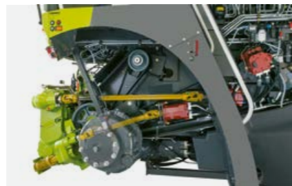
Регулируемый привод приставки JAGUAR 900 (тип 498)
