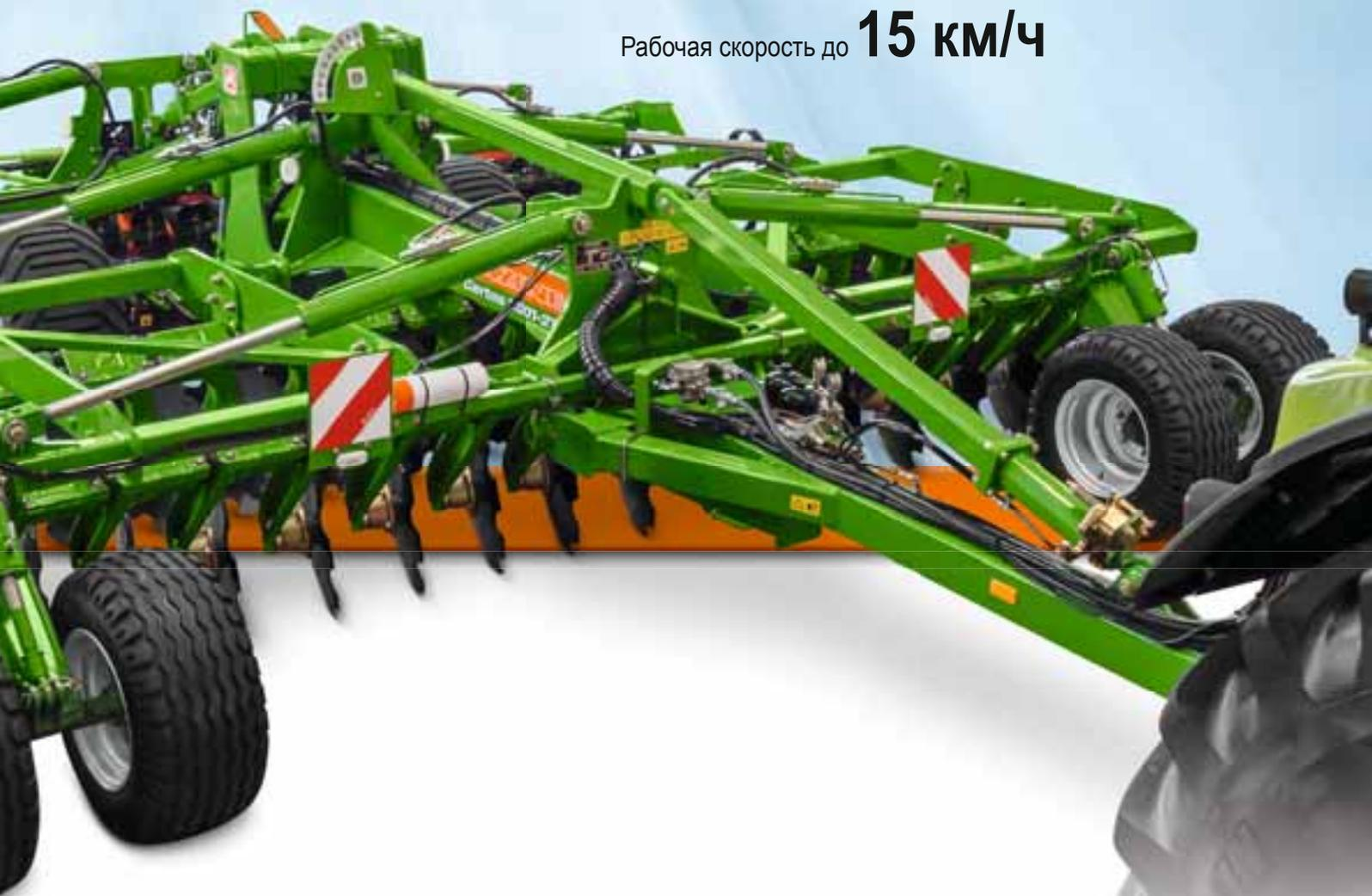
Прицепная дисковая борона Certos-2TX идеально подходит для обработки почвы с интенсивным смешиванием, а также среднелюбной обработки почвы. Диски 660 мм на Certos-2TX проникают в почву на глубину до 20 см и заделывают большое количество органического материала без засорения. Благодаря широкому спектру работы Certos-2TX с шириной захвата от 4 м до 7 м представляет собой мощное универсальное орудие для любого хозяйства.
