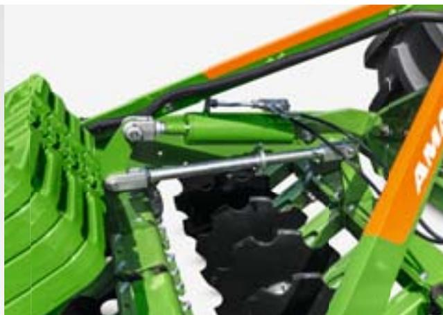
Гидравлическая регулировка глубины обработки
