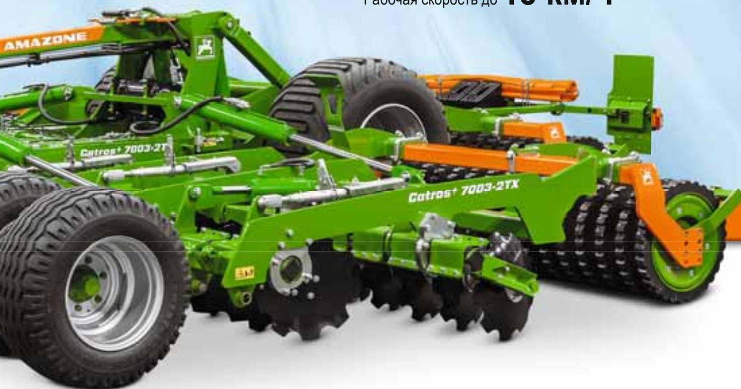
Прицепная дисковая борона Catros-2TX идеально подходит для поверхностной обработки почвы с интенсивным смешиванием. Центральное шасси обеспечивает высокую маневренность машины и позволяет быстрое и безопасное движение по общественным дорогам, несмотря на ширину захвата от 7 м до 9 м. Ярко выраженная плавность хода и низкая тяговая потребность гарантируют высокий комфорт движения при максимальной действенности.
