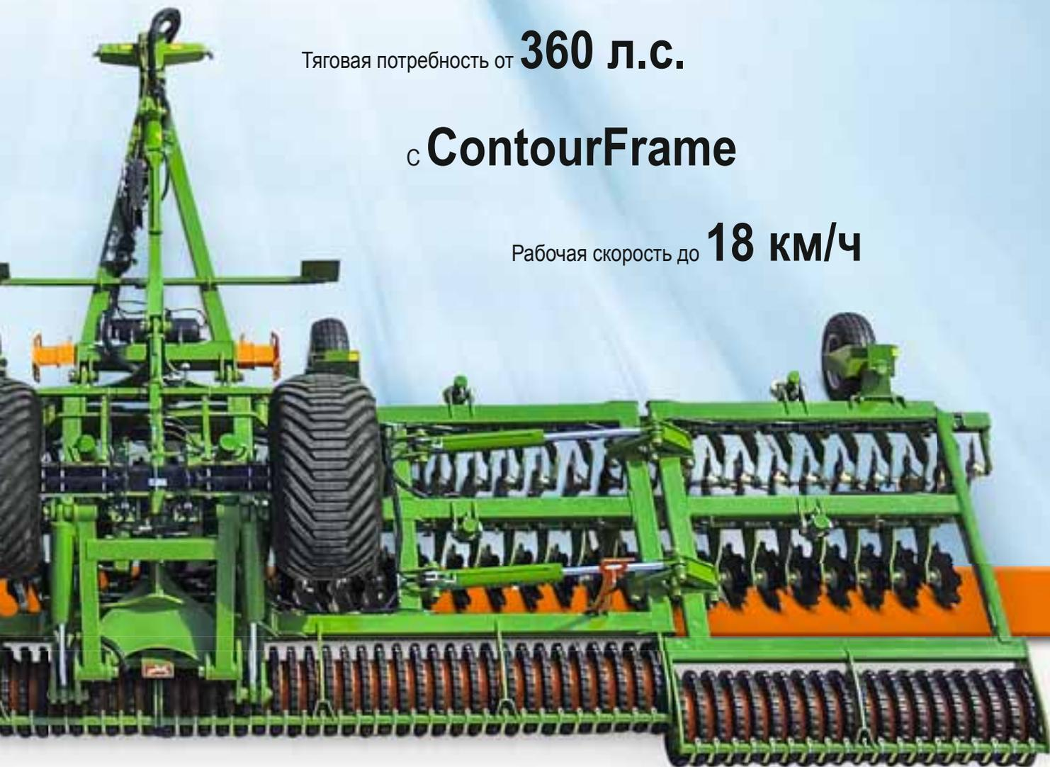
Прицепная дисковая борона Catros+ 12003-2TS идеально подходит для поверхностной обработки почвы с интенсивным смешиванием. Благодаря особой тяговой потребности и несмотря на ширину захвата 12 м возможна особенно высокая скорость и высокая производительность – и в то же время чрезвычайно выгодна при рекордно низком расходе топлива.
