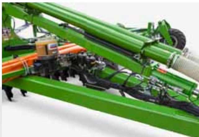
Централизованная система смазки на Catros<sup>+</sup> 12003-2TS
