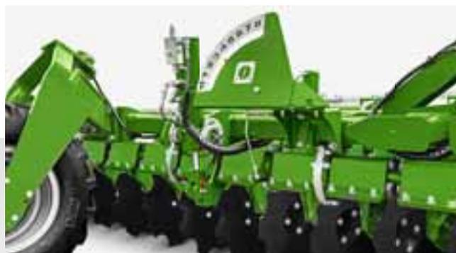
Гидравлическая регулировка глубины обработки с четкой шкалой
