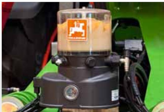
Насос с резервуаром для смазки
