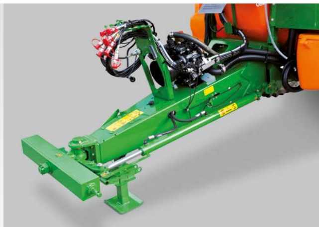
Управляемая ось UniTrail с дышлом Hitch для UniTrail при работе на поле.
