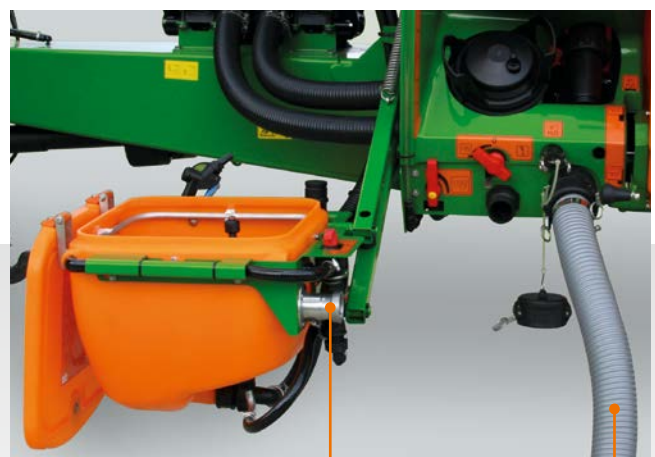
Муфта Ecofill – чистое заполнение из больших емкостей
