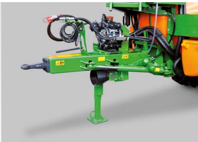
Дышло верхнего крепления, управляемое
