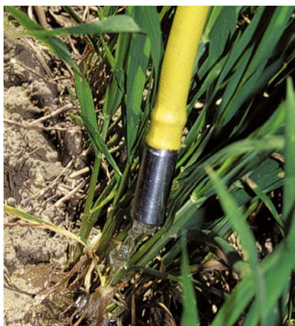
✔ Грузы из нержавеющей стали на шлангах для жидких удобрений
