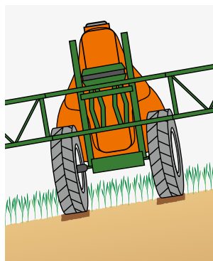
Активированная регулировка на склоне при рулении AutoTrail
