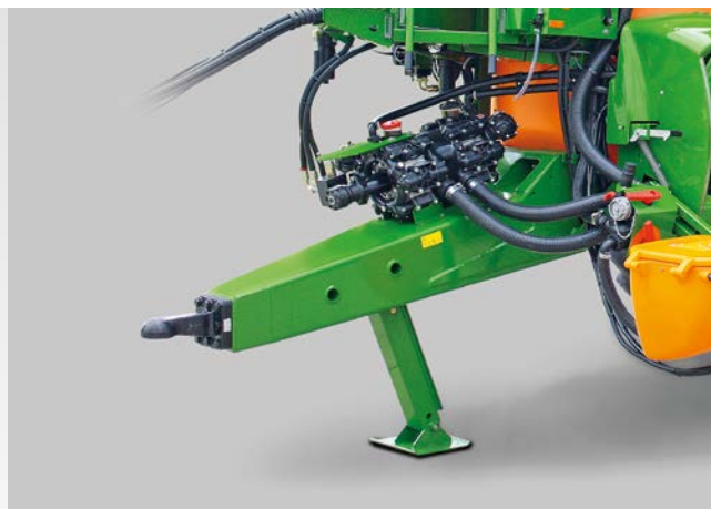
Дышло Hitch, жёсткое, с гидравлическим приводом насоса
