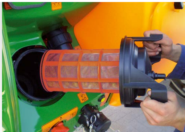
При полностью заправленном агрегате фильтр грубой очистки можно открыть без потерь раствора.
