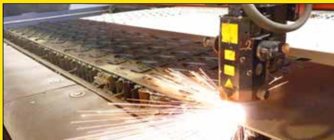
Платформа лазерной резки
