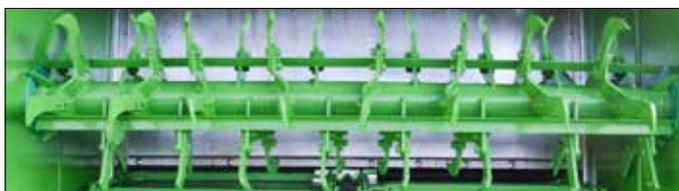
Разбрасывающий механизм, состоящий из двух вертикальных битеров диаметром 600 мм и двух тарелок, обеспечивает эффективное измельчение и разбивание комьев навоза.
