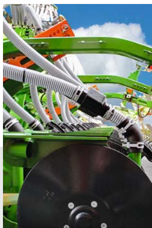
Датчик для фиксации потока посевного материала на высевальном сошнике
