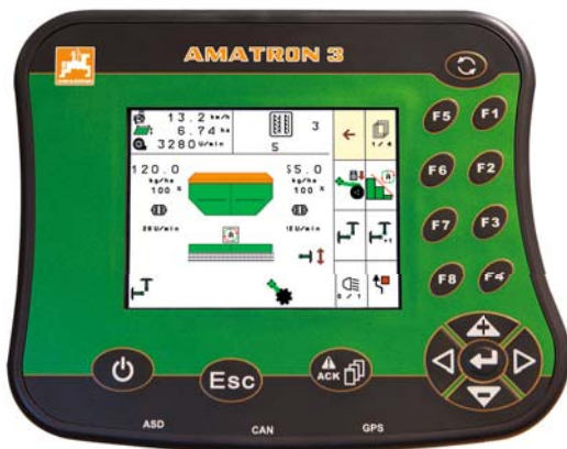
AMAZONE AMATRON 3 большой дисплей диагональю 5,6 дюйма
