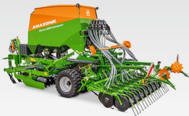
Cirrus 3003 Compact с двухдисковым сошником TwinTeC +
