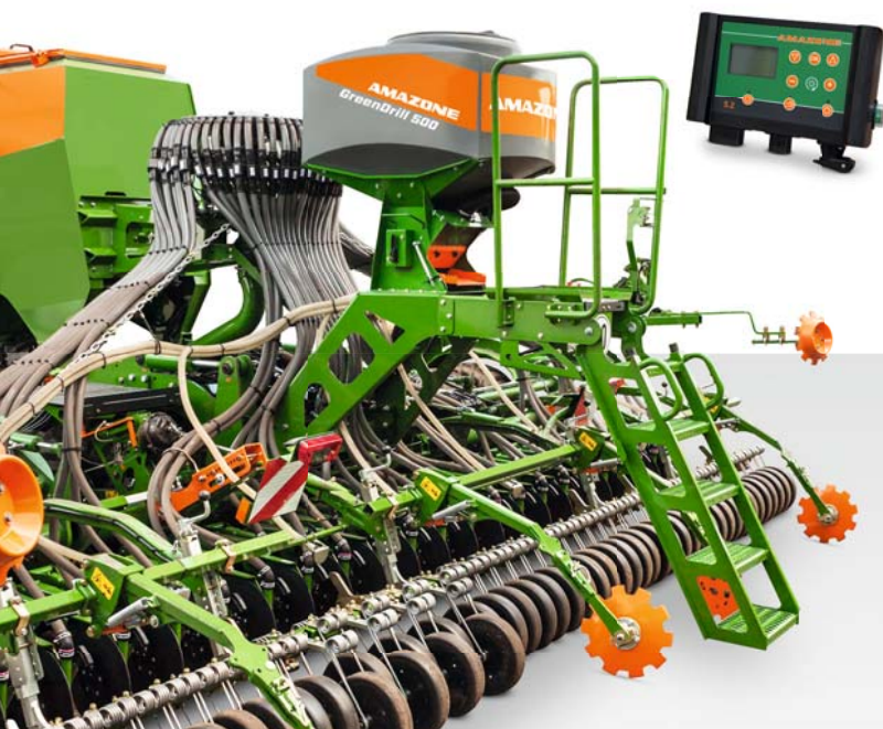
GreenDrill 500 на Cirrus 6003-2С подходит для подсева или внесения гранулированного средства против улиток
