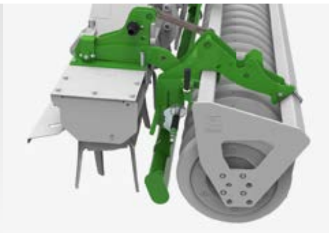
✓ Регулируемая планировочная балка
