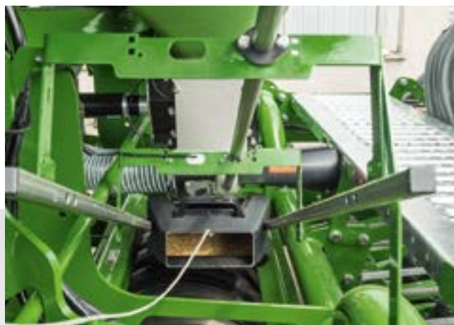
✓ Калибровочный лоток в положении калибровки
