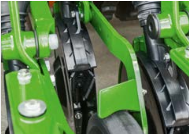
Чистик для прикатывающего катка (специальное оснащение)
