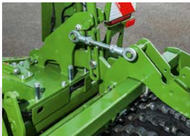
✔ Параллельное ведение катка
