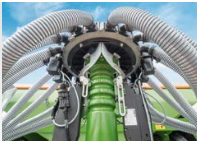
Сегментная распределительная головка с электрическим односторонним включением
