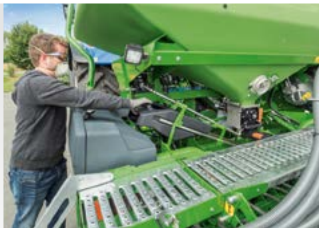
✓ Съёмный калибровочный лоток
