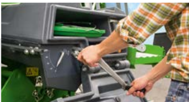
Централизованная настройка глубины укладки
