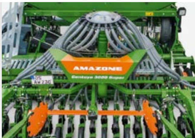
Centaya Super с сегментной распределительной головкой
