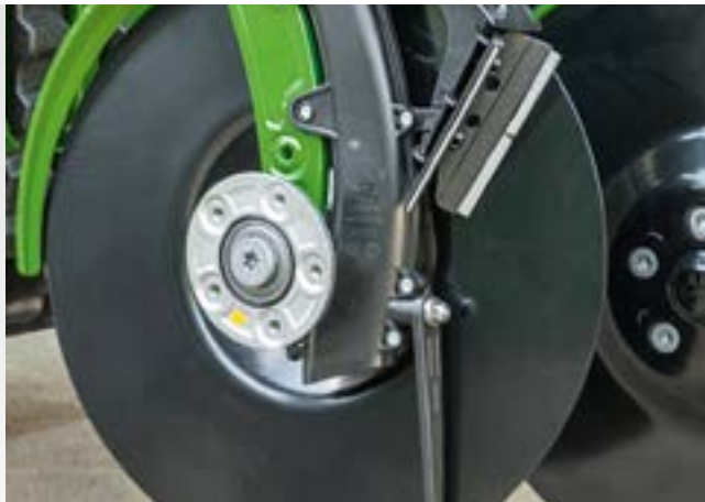
Твердосплавный внутренний чистик (специальное оснащение)
