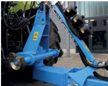
Устойчивая башня плуга
