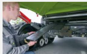
Раздельное подготовительное днище с возможностью демонтажа
