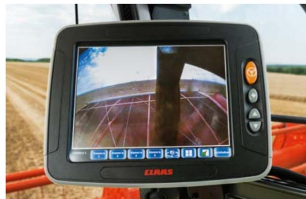
Всего же к системе может быть подключено до четырех видеокамер, синхронно транслирующих изображение на цветной монитор, а также терминал S10 в кабине комбайна.
