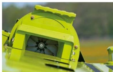
Для свободного обзора: отсос пыли на наклонной камере
