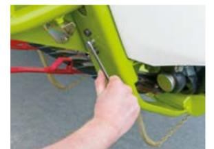
Простая регулировка стеблелителя по высоте с помощью складного ключа
