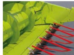
Стол жатки задвинут – уборка зерновых (-100 мм)
