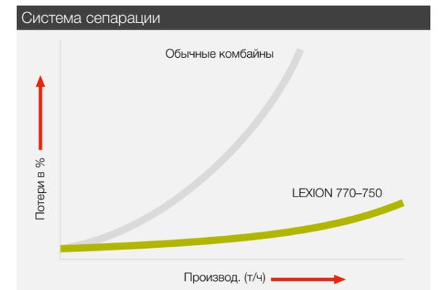
Начиная с определенного уровня производительности, потери при использовании обычных комбайнов резко повышаются, т. к. в данном случае система сепарации выступает в качестве ограничивающего фактора. LEXION благодаря ROTO PLUS обеспечивает эффективную сепарацию зерна с сохранением стабильно низкого уровня потерь.
