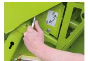
Блокировка стеблелителей без инструмента с помощью быстродействующего затвора
