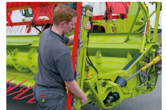
Установка рапсовых ножей с помощью быстродействующего затвора
