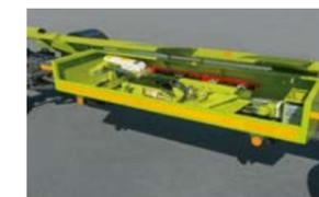
Запирающийся ящик для транспортировки оборудования для уборки рапса
