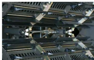
Регулируемые с помощью гидравлической системы пластины ротора для изменения площади сепарации
