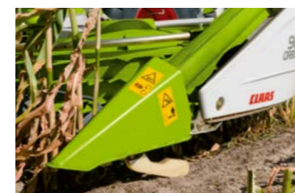
AUTO CONTOUR, регулирование давления прижатия с поперечной компенсацией
