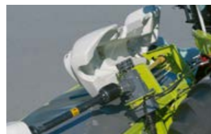
Гидравлическая муфта для включения шнека и косилочного бруса с задержкой
