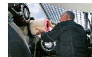
Замена воздушного фильтра без использования инструментов
