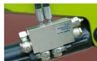
Благодаря электрическому переключению из кабины предохранительные клапаны погрузчиков серий FL и FL C комбинируются с функцией гашения колебаний SHOCK ELIMINATOR.
