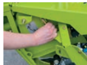
Фиксиране на делителите и ножовете за рапица с бързодействащ затварящ механизъм без инструменти
