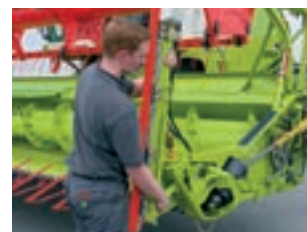
Монтаж на ножовете за рапица с помощта на механизъм за бързо затваряне
