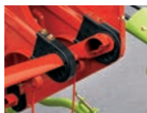
Пластмасови носачи и лагери за палците на мотовилото с оптимизирана форма за по-малко поемане на слама
