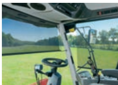
Огледала за обратно виждане с електрическо преместване и предни и странични щори за оптимална видимост
