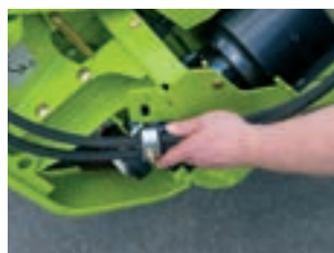
Лесно окачване на хидравличните маркучи за задвижването на ножовете за рапица
