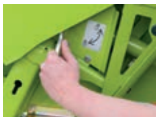
Фиксиране на делителите с бързодействащ затварящ механизъм без инструменти
