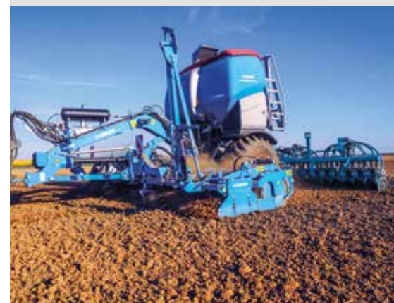
Равномерное распределение веса при помощи разгрузки шасси
